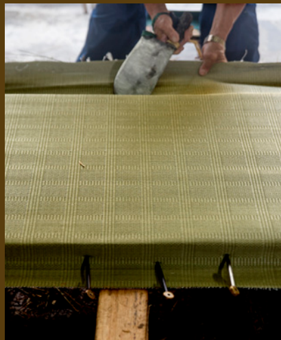
2. 畳表を被せたら待ち針で固定し、縫い上げていく。
