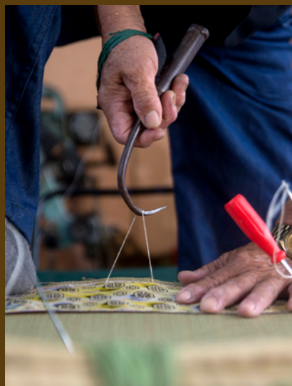
4. 閉め鉤で糸を締め、四つ角の縫い合わせ部分を強化する。
