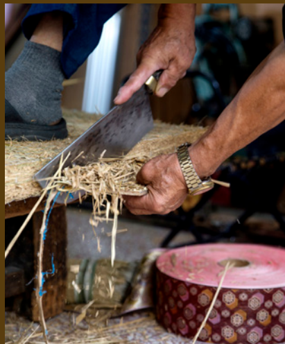
1. 寸法を定め、端の余分な部分を切り落とす。
